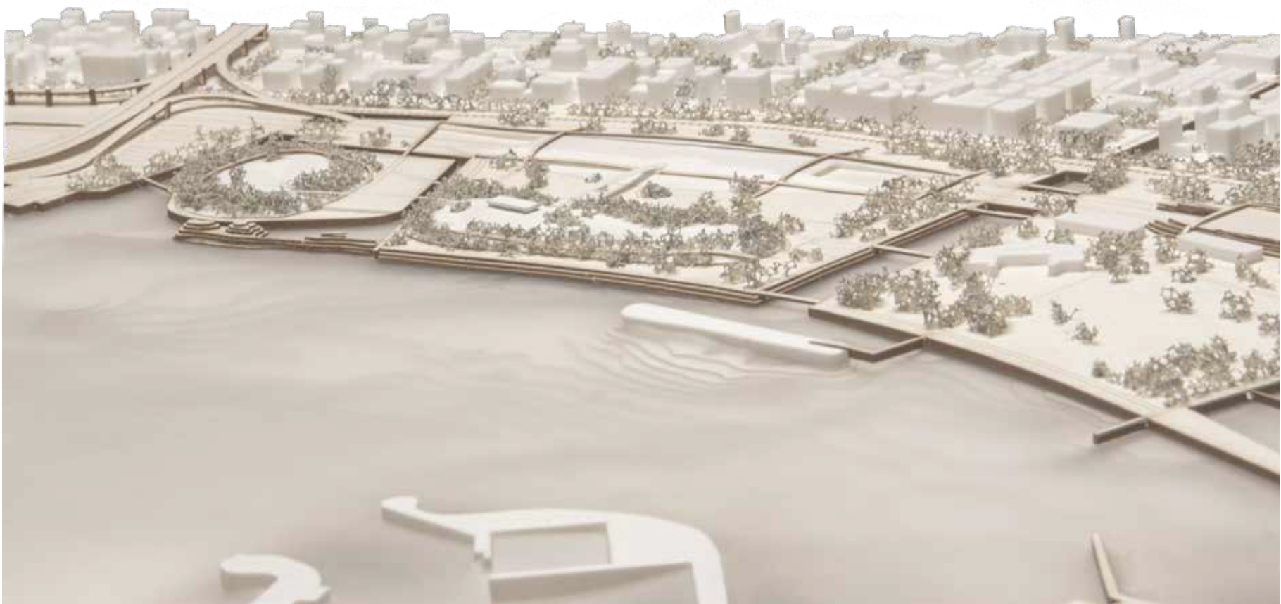
Maquette de la Baie de Phalère (Faliro) : Carton bois, impression 3D, découpe laser et mousse synthétique pour la végétation.
